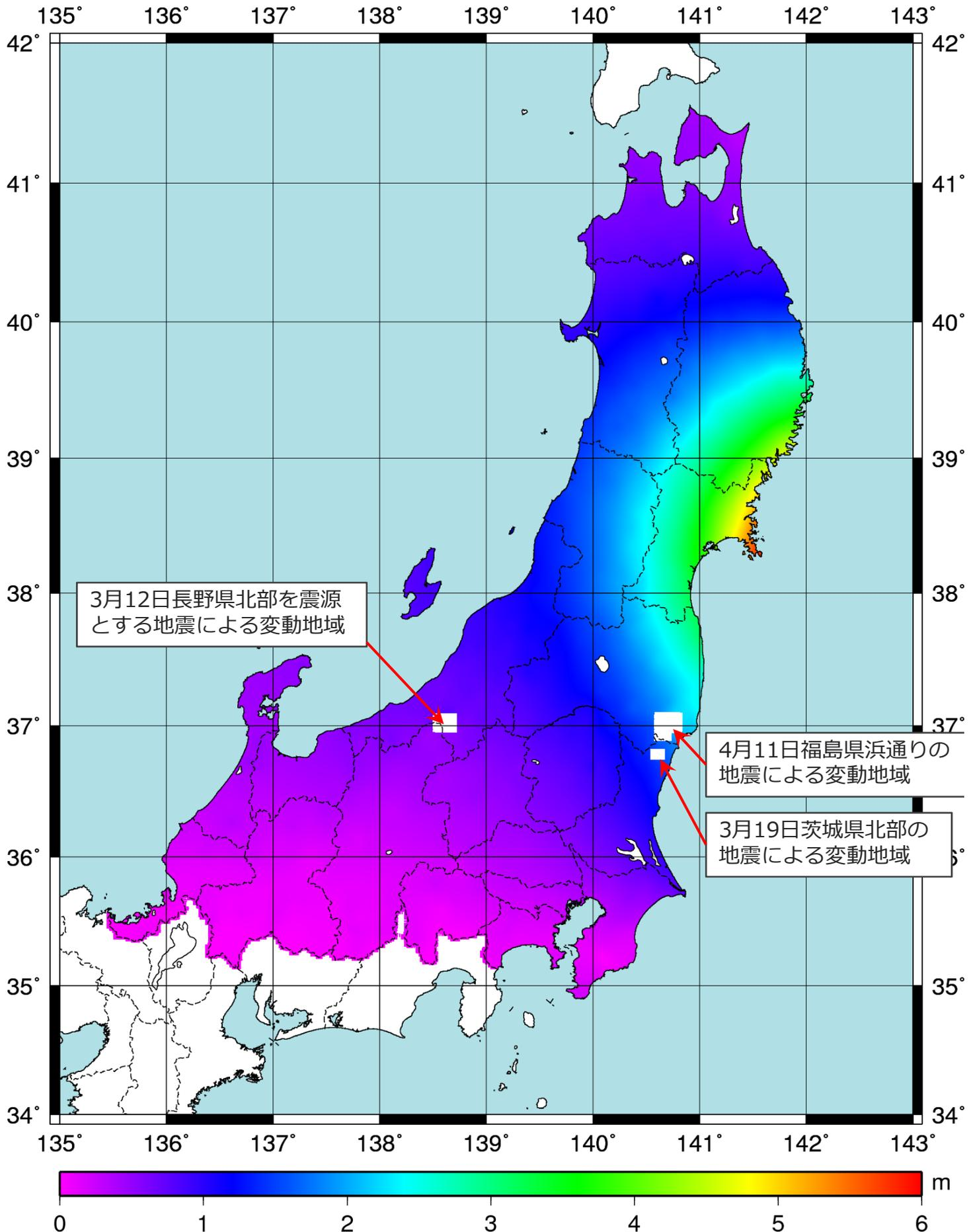
座標補正パラメータは、地殻変動によって生じた水平方向の公共測量成果等のずれを補正するためのもので、国土地理院が実施した再測量作業のデータをもとに作成した格子点ごと（約1kmメッシュ）のデータです。
